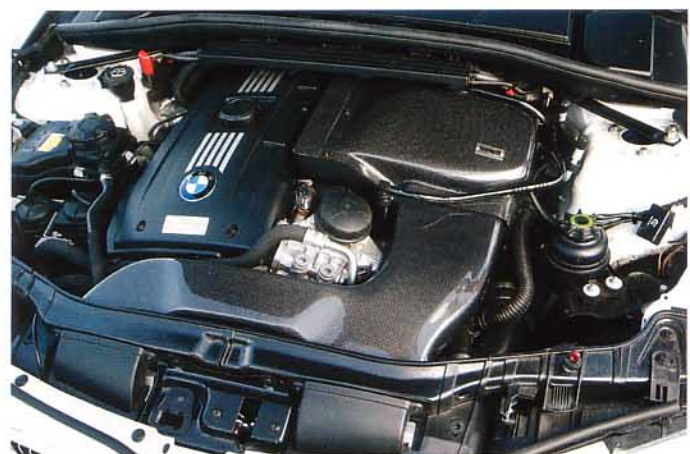
エンジンルームにはカーボンインテークが目目を惹くグループMのラムエアシステムを装着。ターボ過給圧をコントロールするブースターチップはストラットタワー左に確認できる。
