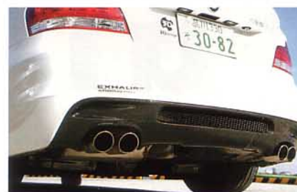
リヤディフューザーにはカーボンが使用され本格派の扱い。現在エキゾーストはアーキユレーを装着する。
