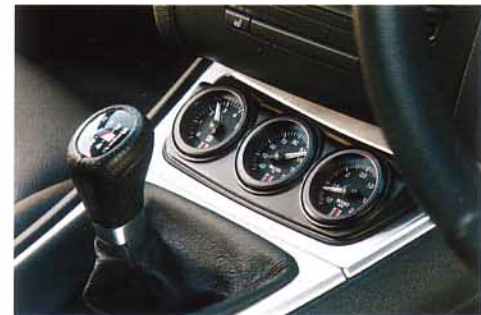
シフト前にはスタックの3連メーターを純正のようにインストール。左から油圧、水温、ブーストの順に並ぶ。
